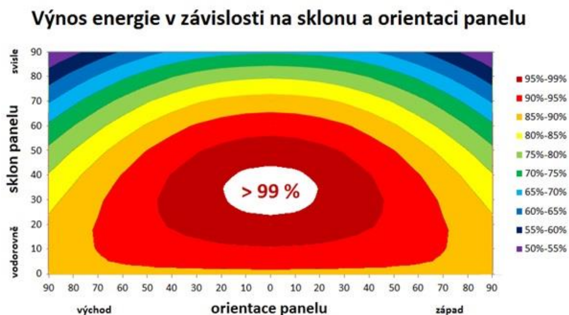
Obrázek 8 výnosy energie vzhledem k orientaci a natočení FV panelů pro ČR [23]
